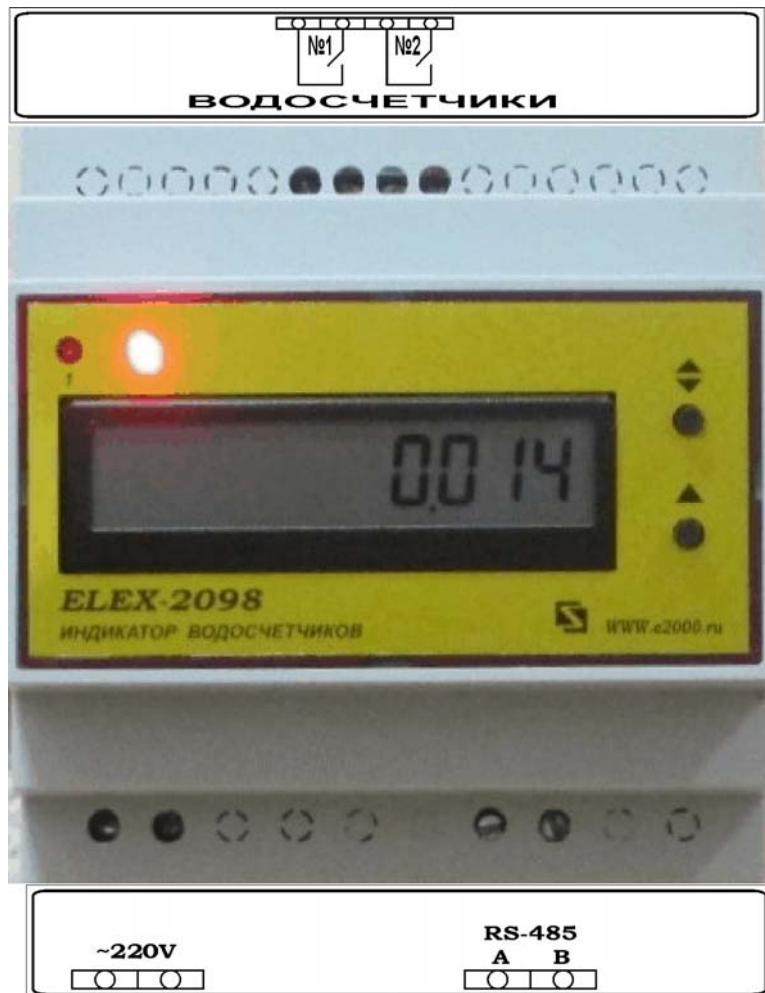
Клеммы «A» и «B» служат для подключения линии связи интерфейса **RS-485** и соединяются с одноименными клеммами устройств сети MODBUS. Скорость обмена – 1200 Бод. Линия связи должна быть проложена отдельно от силовых цепей кабелем **КИПЭВ-1х2х0,6** (или аналогичным) с заземленной оплеткой.
