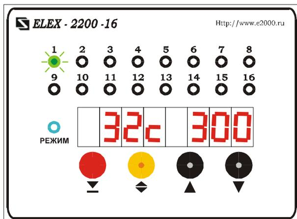
Кнопками «▲» и «▼» можно изменить номер контролируемого канала и просмотреть временные параметры для всех каналов. Если требуется изменить параметры у какого-нибудь канала, этими кнопками устанавливается нужный номер.
