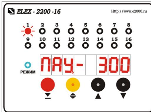
С помощью кнопок «▲» и «▼» сначала изменяют время работы канала  $t_1$ . Переход на следующую страничку коррекции производится кнопкой «**Выбор режима**». Теперь можно установить время паузы – параметр  $t_2$ . Нажатие кнопки «**Старт-Стоп-Ввод**» прекращает режим коррекции и производит запись в память измененных параметров для данного канала.
