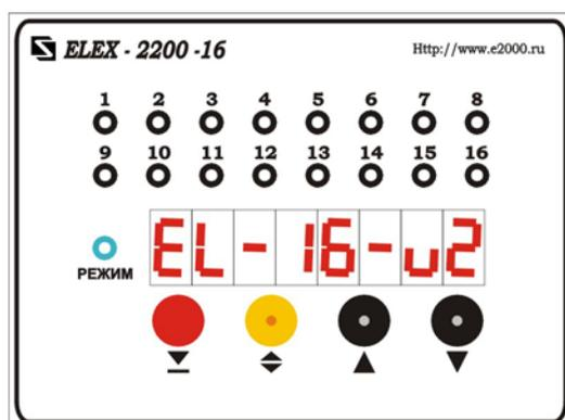
Прибор готов к работе. Контроллер запоминает состояние «Пуск - стоп» режима регенерации, которое было в момент пропадания напряжения. Потому при включении возможен автоматический переход прибора во включенное состояние.
