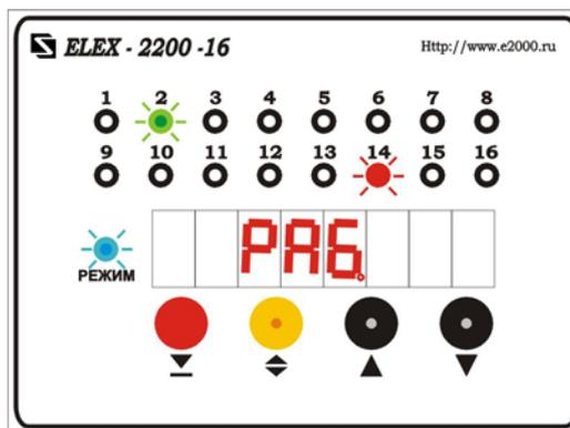
Нажатие красной кнопки «Старт-Стоп-Ввод» переводит контроллер в режим регенерации, при этом мерцает голубой светодиод «Режим», появляется надпись «РАБ», загораются зеленые индикаторы работы соответствующих включенных силовых каналов, зажигаются красные светодиоды аварийных каналов. Управление работой прибора также возможно с помощью внешних кнопок «Пуск» и «Стоп».
