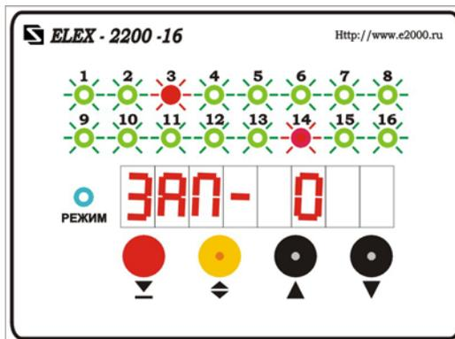
При нажатии красной кнопки «Старт-Стоп-Ввод» включается зеленый светодиод выбранного канала, на выходе соответствующего канала появляется напряжение, необходимое для включения клапана. Время открытия клапана равно времени удержания кнопки. Таким образом, можно вручную проверить правильность коммутации цепей питания исполнительных устройств, а также работоспособность подключенных клапанов. В этом режиме возможно открытие даже заблокированных каналов.
